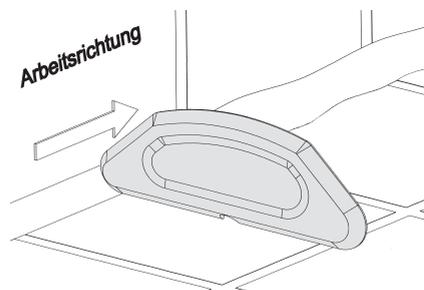
10. In regelmäßigen Abständen Überschüsse von Dichtstoff, die sich beim Abziehen auf der Schablone anhäufen, in entspanntem Wasser abstreifen oder mit Toilettenpapier reinigen. Toilettenpapier in einem bereitgestellten Eimer entsorgen. **Achtung keine Lösungsmittel verwenden.**
